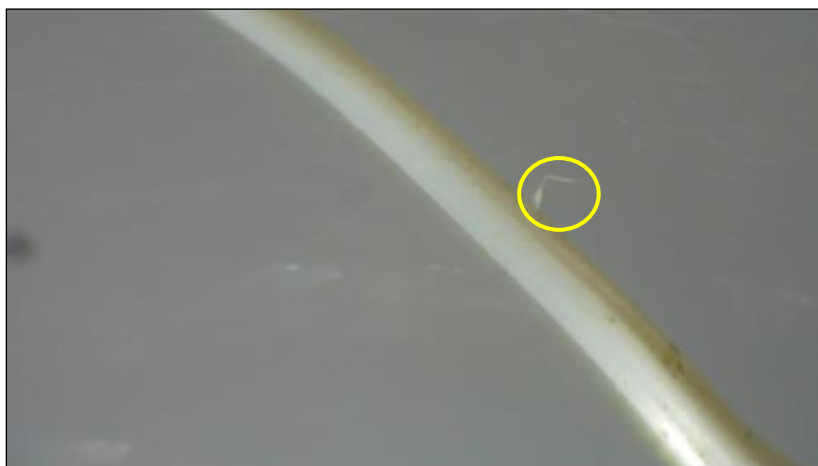
Figura 7: campione di Bio Net al microscopio, con evidenziati segni di degrado
